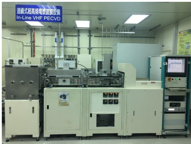
圖為財團法人金屬工業研究發展中心自主開發之「連續式超高頻電漿鍍膜設備 In-Line VHF PECVD for HIT Solar Cell」
