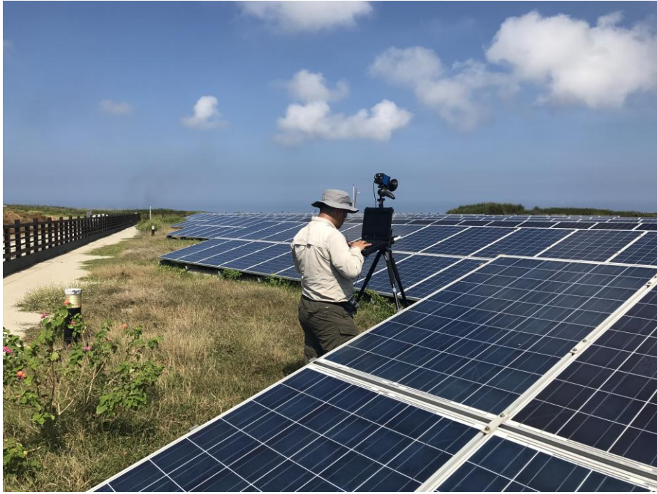
圖 1：太陽光電電站戶外 EL 缺陷測試服務
